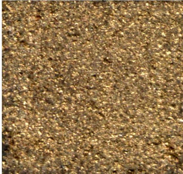
**Figura 5. Strat obținut prin metoda depunerii pulberilor metalice prin descărcări electrice în impuls cu rupere de contact (Catod – otel-45; Anod – BrOTs-5-5-5. Pulberi metalice BrA-7. Imagine mărită × 20.)**
